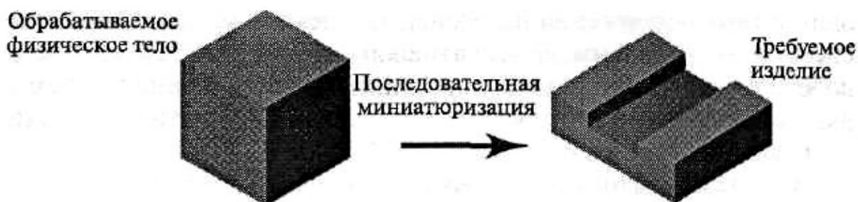
Сурет 1 - Жасалу жолы: жартылай өткізгішті техникадағы литография
